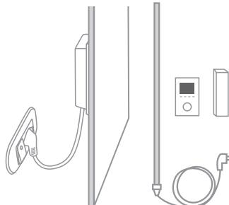
Resistenza solo a sinistra e inserita verticalmente nel radiatore.
